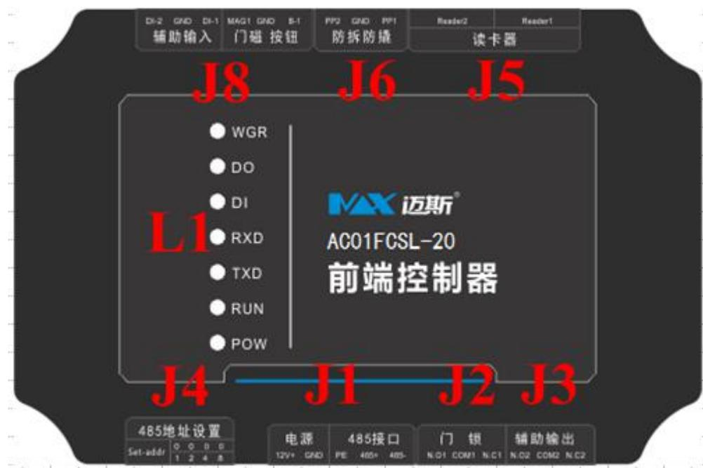
图 4-5 AC01FCSL-20 门禁前端控制器端口说明图
